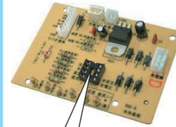
簡単に抜き差し出来るソケットを使って実験
